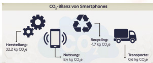
Abb. 2: CO 2 -Fußabdruck eines Smartphones (Fairphone 3). Fast drei Viertel des Ausstoßes von Treibhausgasen entfällt auf die Produktion.
